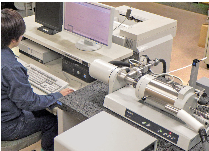
最小分解能0.125nmの高性能熱膨張測定器も装備
